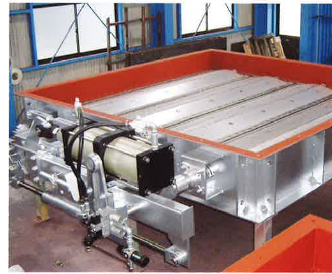
耐熱弁 材質STEN2+ハステロイ
