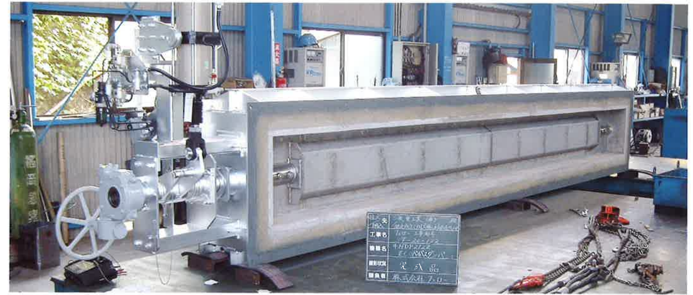
耐熱弁(キャスター張) 羽根SUS3106 軸インコロイ
