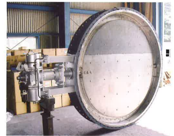
高温高ガス閉切ダンパー 材質・内面ハステロイ張 外面SS400
