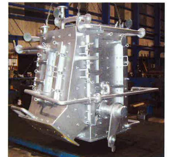
水冷弁2重構造3方弁 内面SB機 外面SS機 内部SUS310Sライナ張
