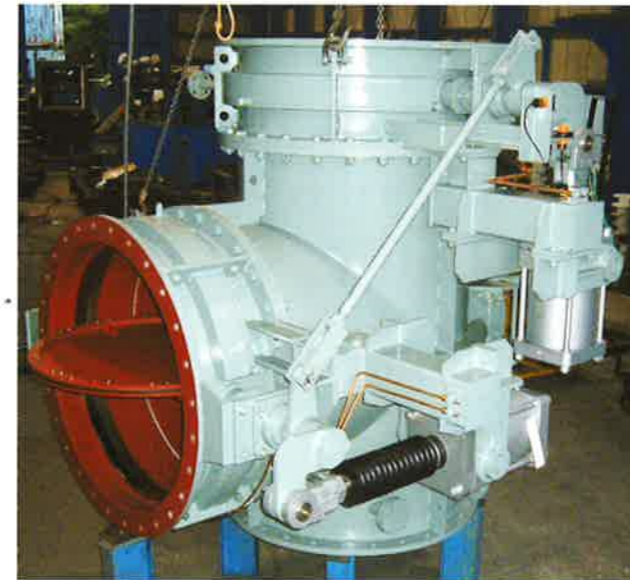
完全密閉型3方弁 材質SS400+SUS304
