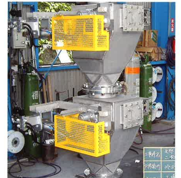
灰脱2段ゲート 材質SUS304
