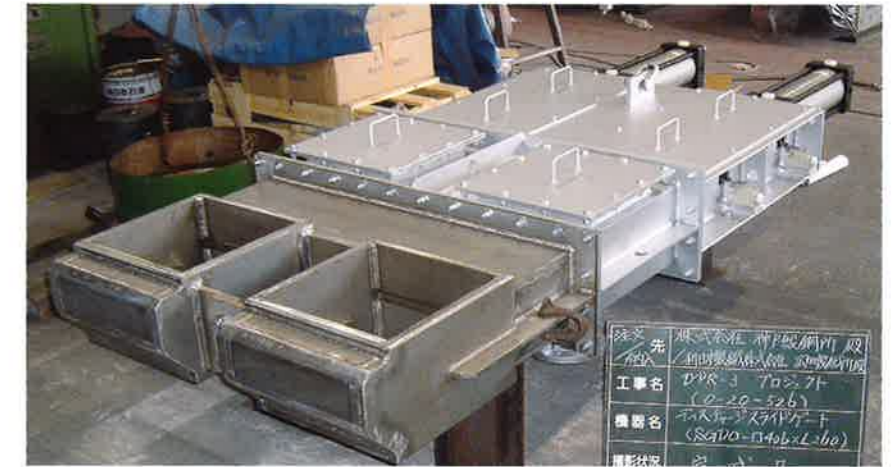
完全密閉型スライドゲート 材質SUS316L
