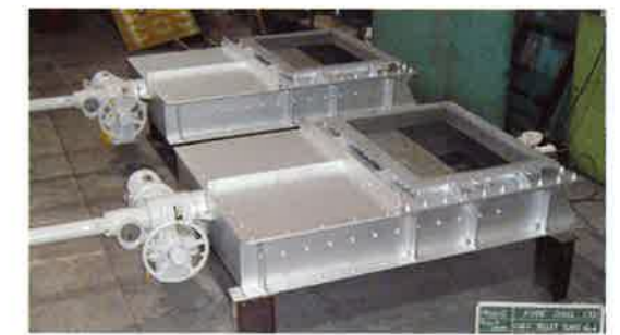
完全密閉型スライドゲート 材質SUS316L
