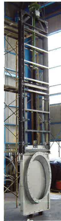
完全密閉型ギロチンダンパー 材質STEN
