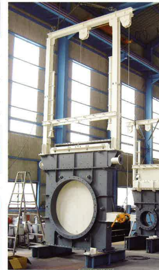
完全密閉型ギロチンダンパー 材質STEN
